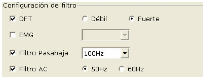
Configure los filtros en la interfaz de configuración de la muestra (Figura 9-2).
