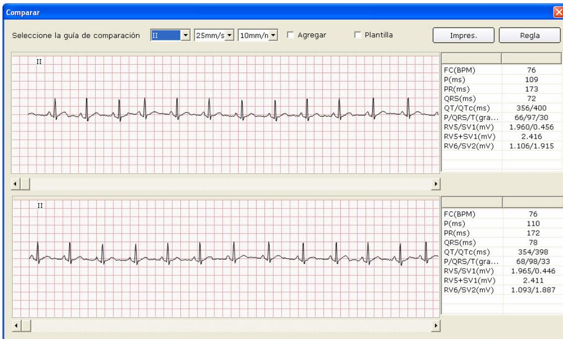
Si selecciona **Agregar**, se visualizarán en la interfaz las ondas de los dos registros de examen. La onda de color negro es la onda original y la onda azul es la onda comparada. Puede arrastrar la barra de desplazamiento de la parte inferior para ver todas las ondas de los dos registros de examen.
