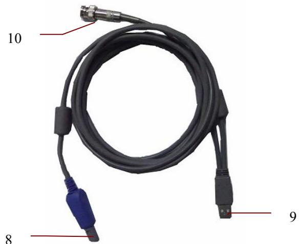
Cable de ECG de esfuerzo
