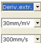
Puede escoger el grupo de derivaciones, la ganancia y la velocidad de las ondas mostradas en la parte inferior de la interfaz de análisis del ECGAR.
