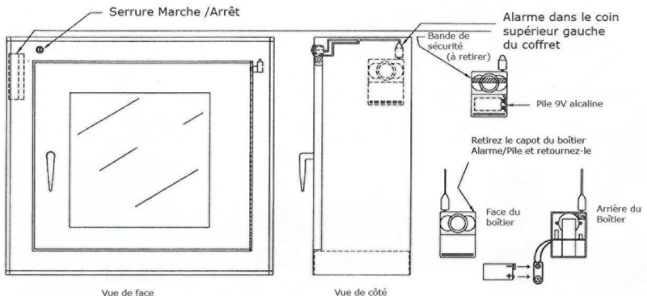
NOTE : Retirez l'adhésif prévu pour le transport sur la face du boîtier Alarme/Pile et éliminez-le.
